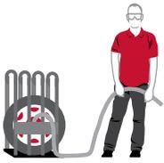
L'explosion de l'ensemble pneu/jante en raison d'une pose mal réalisée peut causer des blessures graves et même la mort. Utilisez une cage de sécurité et une rallonge de tuyau à air. Seules les personnes spécialement formées doivent poser des pneus.
